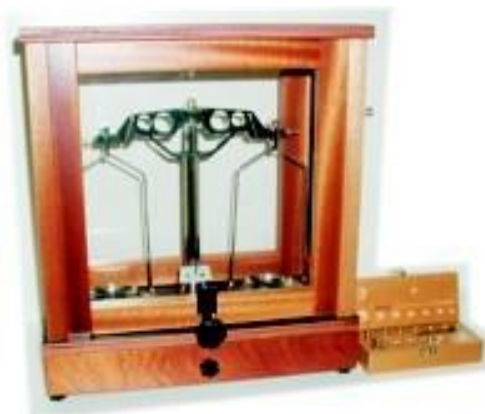
Bilancia sensibile a 1 mg portata almeno 50 g
